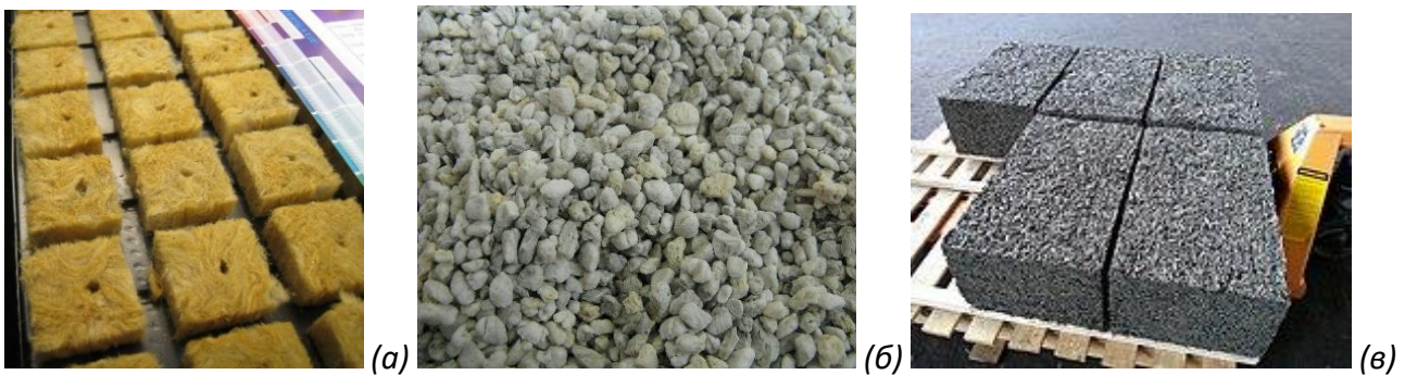
Рисунок 3 – Зразки ізоляційних матеріалів: а) мінеральна вата; б) перліт; в) арболіт
