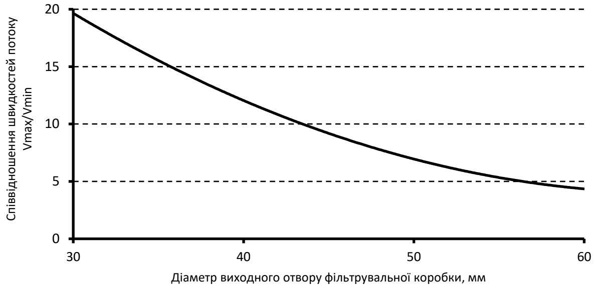
Рисунок 5 – Крива залежності розподілу відносної швидкості повітряного потоку від розміру діаметру вихідного отвору
