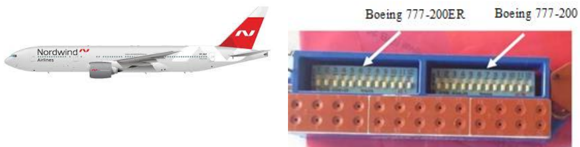
Рисунок 8 – Літак Boeing B777-200ER зі схемою перемикування контактів блоку обробки кількості палива для Boeing 777-200ER та Boeing 777-200 [13]
