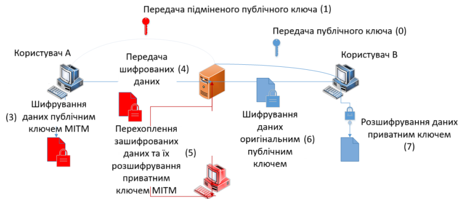
Рисунок 2 – Схема проведення MITM атаки на підміну ключів шифрування
