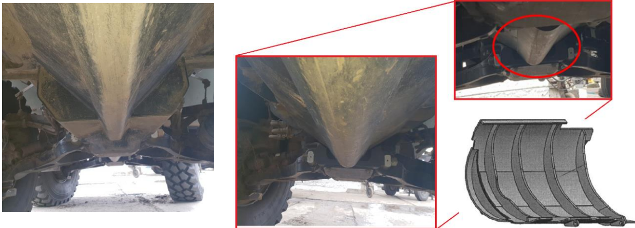
б - V-подібний протимінний екран
