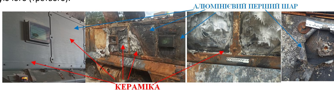
Рисунок 14 – Додаткова дисперсно-керамічна броня Тайфун-К
