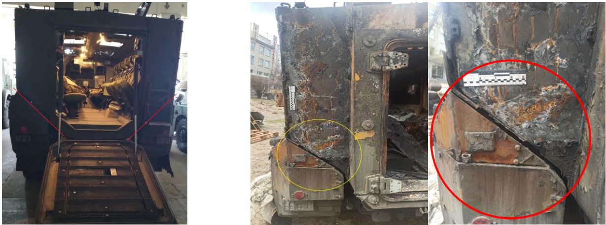
а - скоси на днищі десантного модуля "Тайфун-К"
