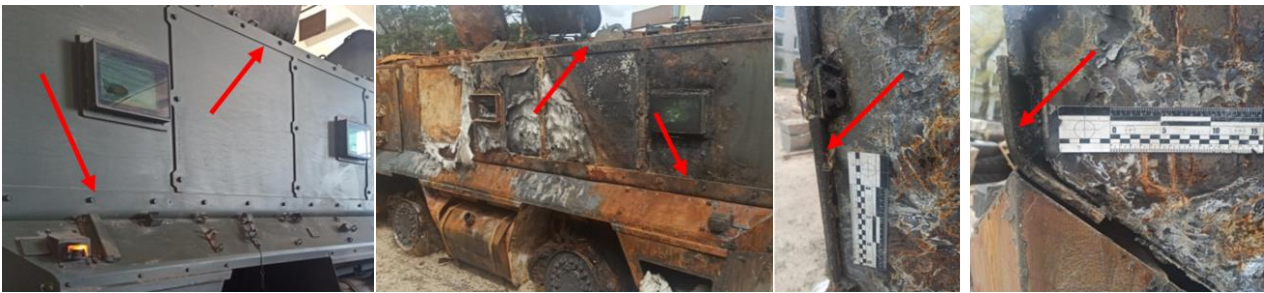
Рисунок 10 - Перекриття з'єднань елементів корпусу
