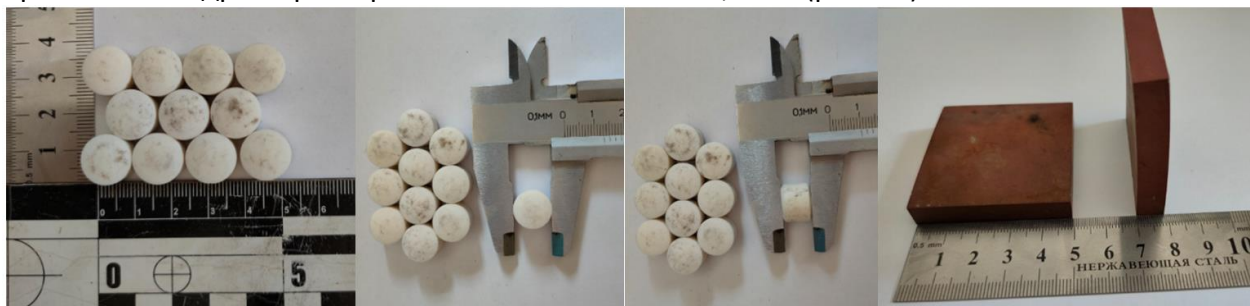
Рисунок 15 – Керамічні елементи бронювання КамАЗ-63968 "Тайфун-К"
