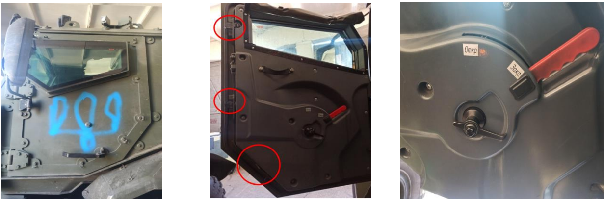
Рисунок 11 – Триточкові механізми замикання дверей кабіни “Тайфун-К”
