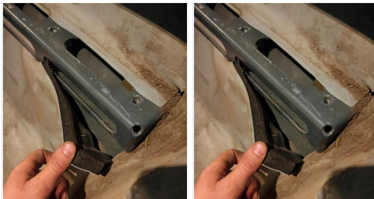
Рисунок 25 – Протиосколковий підбій “Тайфун-К”
