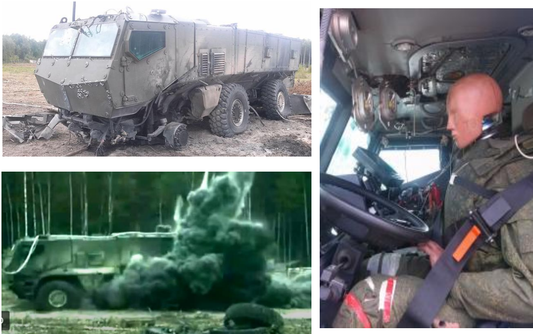
Рисунок 9 - Натурні випробування підривом на заряді 6 кг у тротиловому еквіваленті
