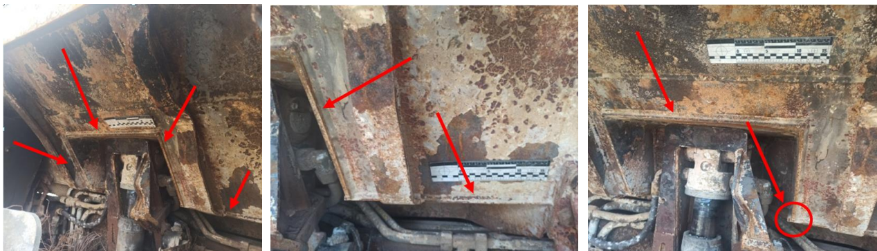
Рисунок 7 - Спосіб зварювання горизонтальних і вертикальних елементів корпусу “Тайфун-К”
