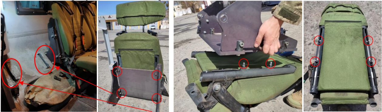
Рисунок 21 – Спосіб кріплення сидіння КамАЗ-63968 “Тайфун-К”
