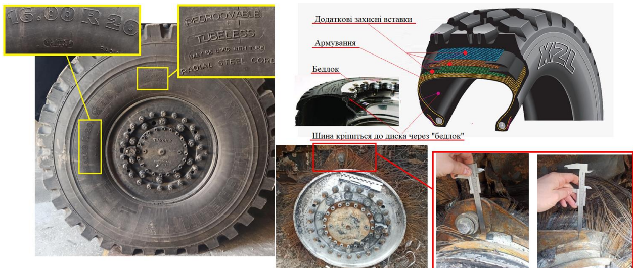
Рисунок 13 – Колесо 16.00 R20 Michelin XZL, елементи армування та роз'ємного обода
