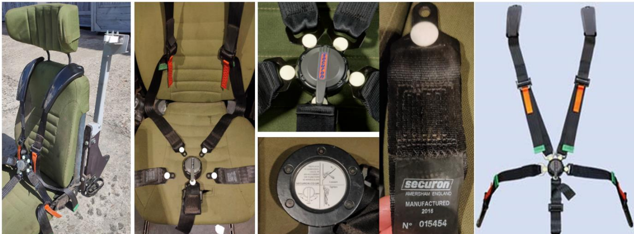
Рисунок 23 – Система фіксації екіпажу та десанту “Тайфун-К”
