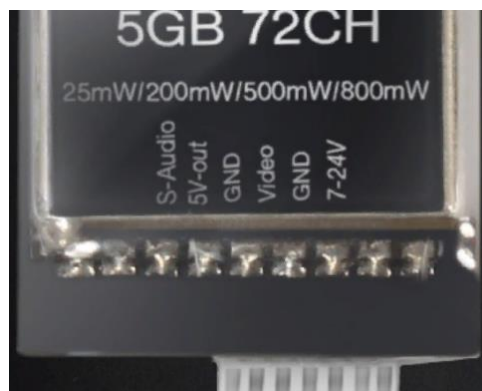
Рисунок 2 – Виводи радіопередавача TBS Eachine TX5258, бачимо вивід протоколу SmartAudio
