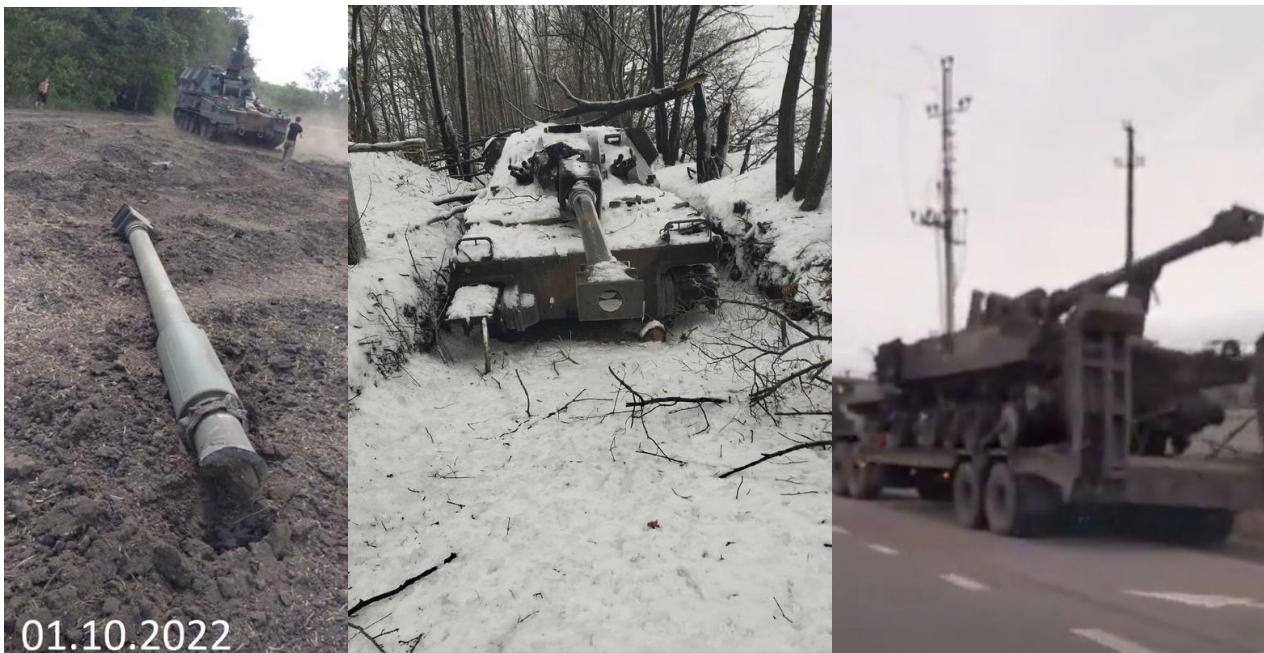
Фото 2 –САУ АНС Krab, що потребували проведення ремонту
