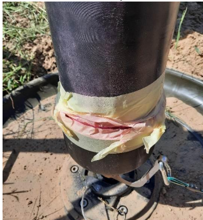
Рисунок 6: Фотофіксація стану індикаційної стрічки після пострілу.
